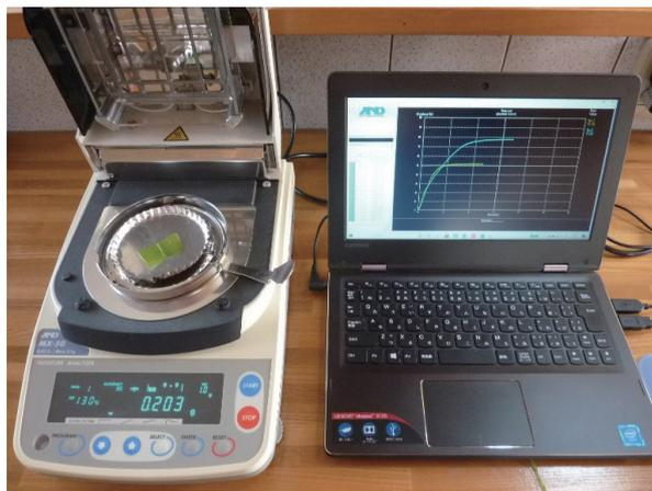
写真 1. 加熱乾燥式水分計による樹葉含水率計測
